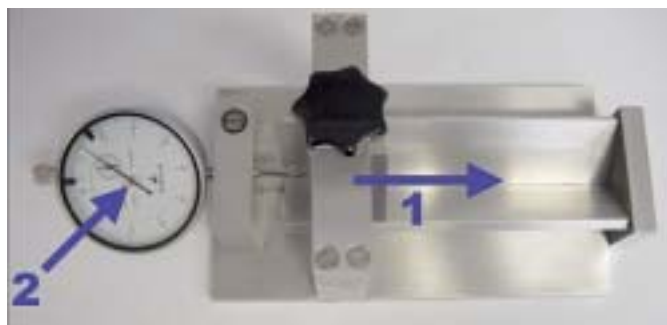
Abb. 5 Extensiomter zum Messen der Ab- bindeexpansion. Pfeil 1: Hier wird die flüssige Einbett- masse eingefüllt Pfeil 2: Skala zum Ablesen der Längenausdehnung des Prüfkörpers
